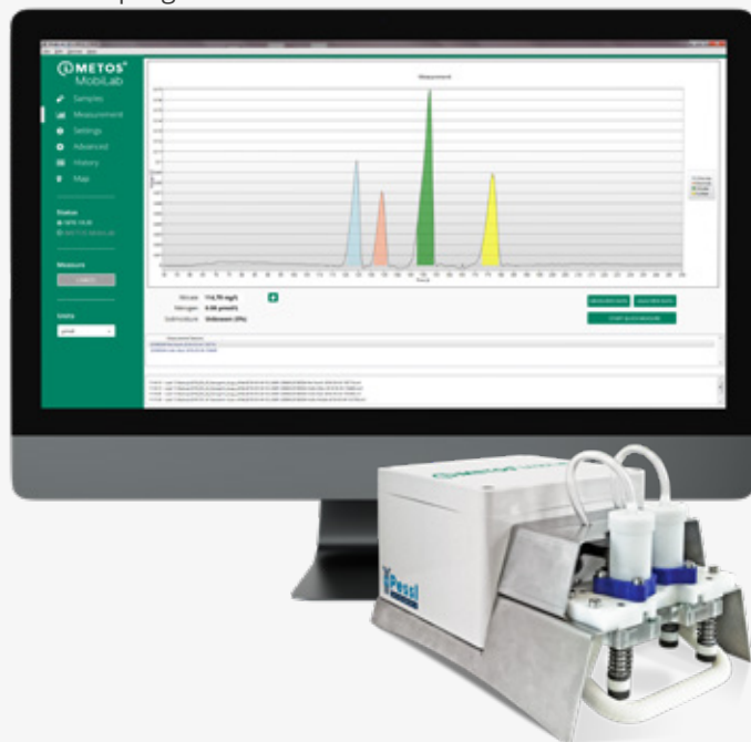
Imagen: resultados del análisis de suelo mostrado como una gráfica en la aplicación de iMETOS MobiLab.
