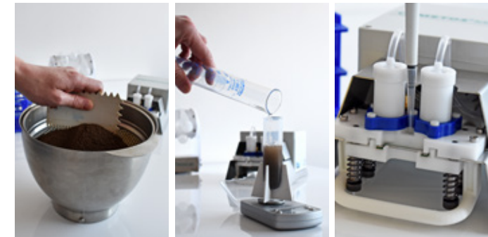
1. Tamizar la muestra de suelo 2. Añadir la disolución reguladora 3. Introducir la muestra en iMETOS MobiLab
