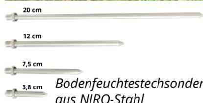
Bodenfeuchtestechsonden aus NIRO-Stahl
