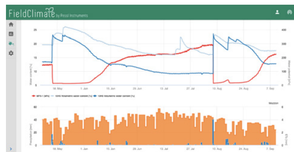
Combinaison des mesures volumétriques de la teneur en eau avec deux profondeurs différentes (bleu et bleu clair) et des données tensiométriques (rouge) sur le vignoble Pinot Noir adulte. Vous pouvez voir la succession des phases d'assèchement et de déficit potentiel, atténuée par les irrigations et les pluies.
