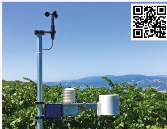
Die Produktlinie iMETOS liefert die Rohdaten (Niederschlag, Blattnässe, Temperatur und Luftfeuchtigkeit), die zur mathematischen Berechnung von Krankheitsmodellen verwendet werden. Sie sind über die Plattform ng.fieldclimate.com erhältlich - für die wichtigsten Pflanzenkrankheiten und Insekten.
