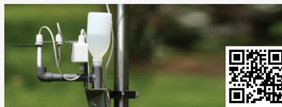
Ereignisse aus der jüngsten Vergangenheit haben bestätigt, dass Spätfrost für die Rebe besonders heimtückisch ist. Dank der Kombination von Feucht- und Trockentemperaturfühler auf der Höhe der untersten Triebe können mit SMS Frühwarnungen zeitgerecht versendet werden. Dank einer sehr genauen und ortsspezifischen Wettervorhersage für die nächsten Stunden kann eine geeignete Frostschutzstrategie festgelegt werden.
