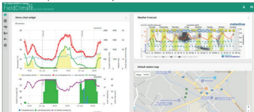
En el lado izquierdo, la casilla de datos de la estación muestra los datos medidos por su iMETOS. Los datos se pueden ver en gráficos y tablas detallados. Puede acceder al menú estructurado, que le permite definir series temporales y exportar datos en tabla / gráfico.
