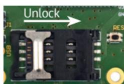
4.1 Deslice la parte metálica del soporte de la tarjeta SIM para desbloquearlo.
