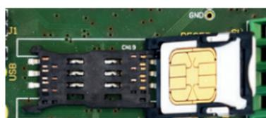
4.2 Coloque la tarjeta SIM en el soporte para que los contactos dorados de la SIM estén hacia abajo en la placa.
