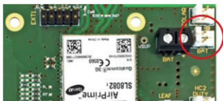
5. Conecte el cable de la batería en el conector BAT de la placa (círculo rojo).
